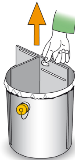
Bei der Reinigung zuerst den Einlauf abnehmen und den Deckel aufmachen. Das stehende Wasser entfernen und den Behälter herausnehmen.
