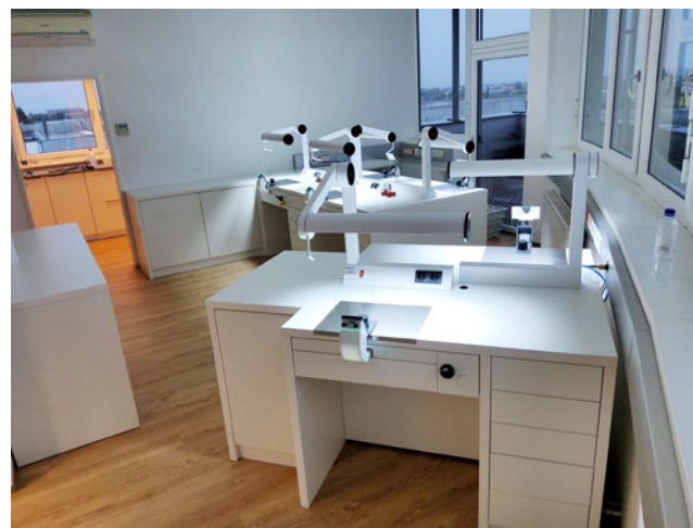
Mesa de trabajo de un puesto TM 1, superficie de trabajo de ultrapasa. Puesto de trabajo para técnico con unidad de succión e instalación para gas y aire.
