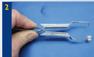
2 Öffnen der Klemme durch Druck auf den hinteren Teil Opening of the clip by pressing the rear part
